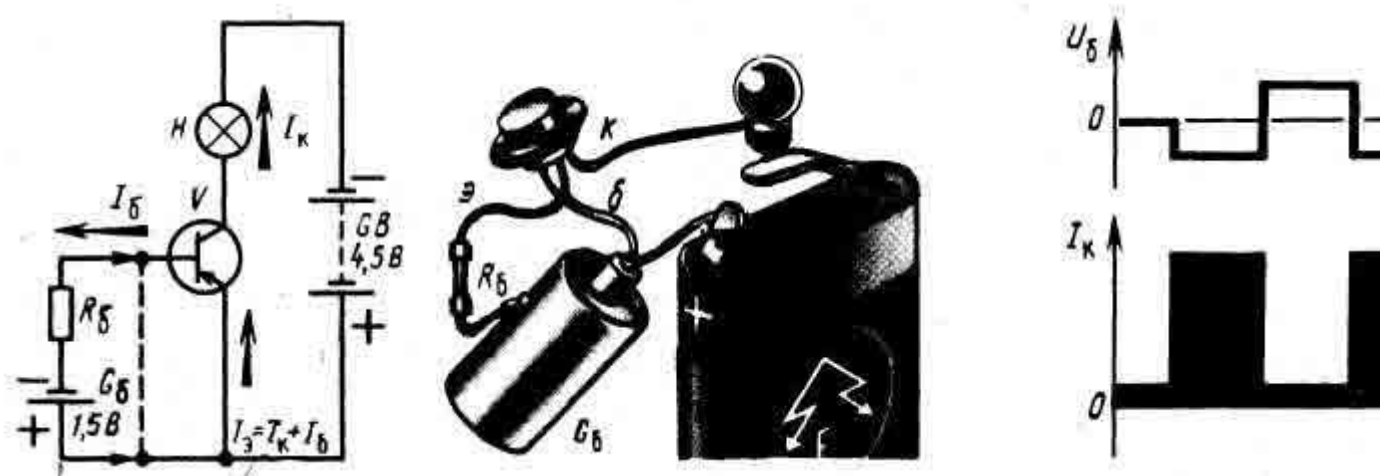
Рис. 2 Опыт, иллюстрирующий работу транзистора в режиме переключения.
