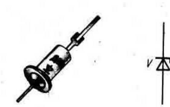
Рис. 8 Стабилитрон и его графическое обозначение на схемах.
