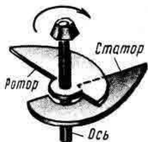
Рис.7 Простейший конденсатор переменной емкости.
