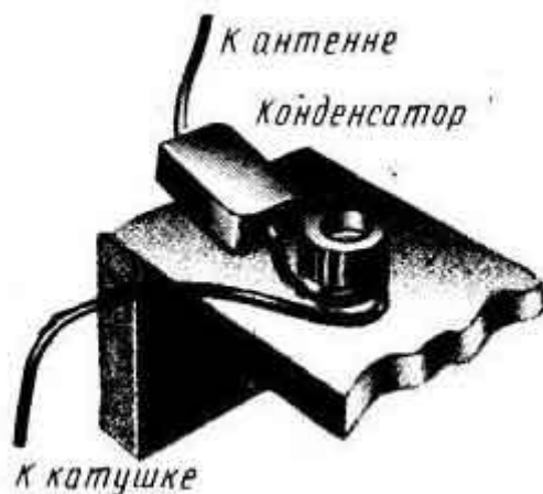
Рис. 4 Конденсатор включенный в цепь антенны, улучшает селективность приемника.
