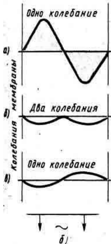
Рис. 14 Графики иллюстрирующие работу телефона: а - переменный ток в телефоне, б - без постоянного магнита, в - с постоянным магнитом.
